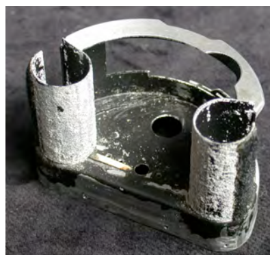
Photos 15, 16 : Fortement corrodés, ces éléments sont sertis.
