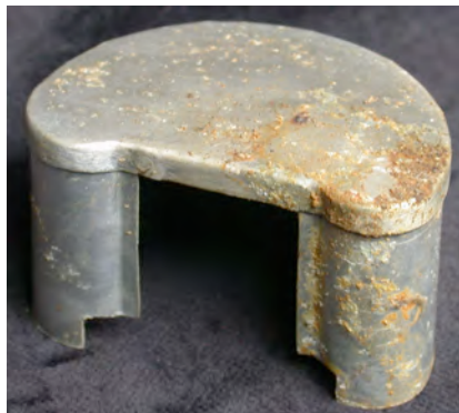
Photos 15, 16 : Fortement corrodés, ces éléments sont sertis.
