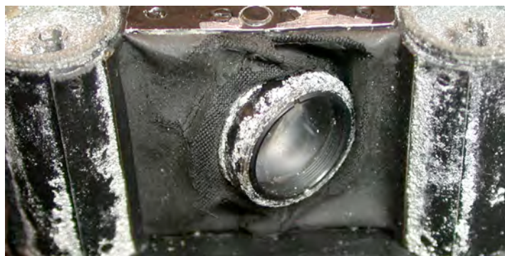
Photo 2 : Détail de la corrosion après démontage du boîtier externe.
