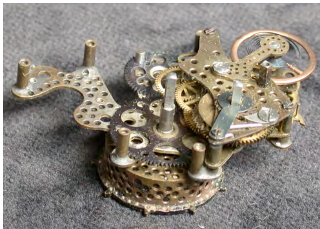
Photo 30 : Les pièces du mécanisme sont allégées par percement de trous dans la matière.
