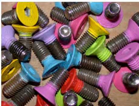
Photo 3 : Quelques vis ayant servis à la protection des pas de vis lors des étapes de traitement.
