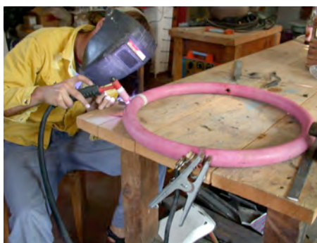
Photo 21 : Soudure de certains tenons défectueux.
