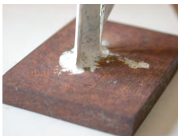
Photos N° 17, 18 : Imperfections comme les taches de peinture sur la base, les irrégularités de la découpe, le renflement des jambes, les taches de rouille au travers de la peinture non couvrante.
