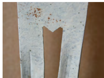
Photos N° 17, 18 : Imperfections comme les taches de peinture sur la base, les irrégularités de la découpe, le renflement des jambes, les taches de rouille au travers de la peinture non couvrante.
