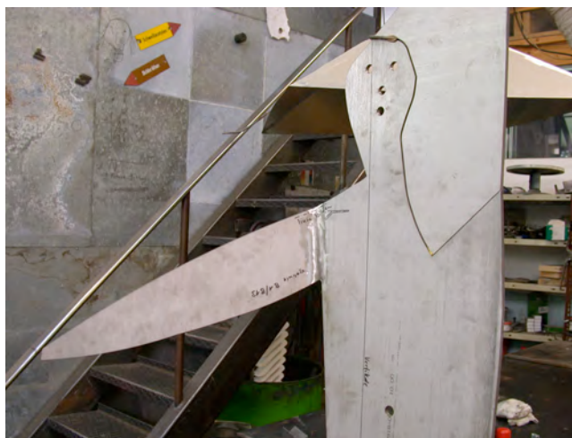
Photo 5 : La sculpture est découpée dans une tôle d'acier inoxydable.
