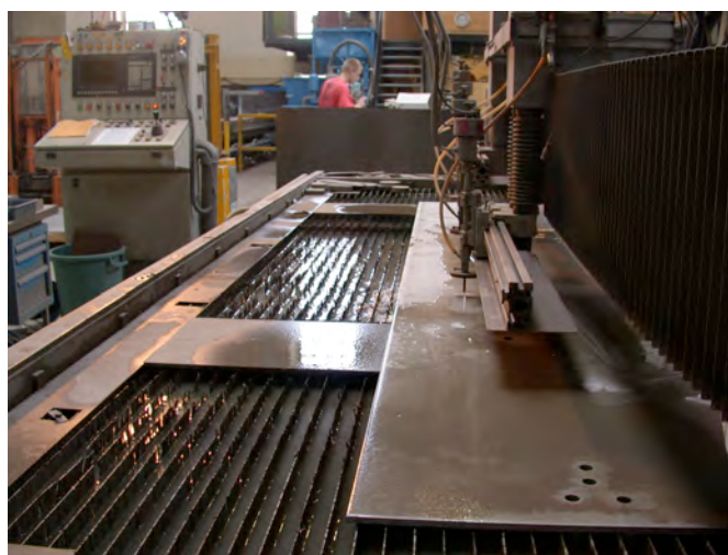
Photo 6 : Découpe par jet d'eau sous pression.
