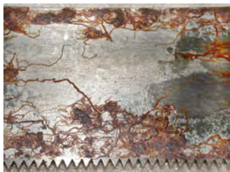
Corrosion filamenteuse se trouvant sous le papier.
