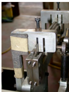
Les tampons buttoirs étaient fixés à l'aide de ruban adhésif papier.
