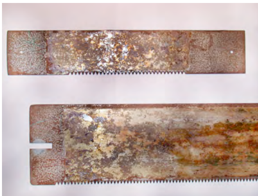
Plaquettes fortement oxydées, recevant les partitions en papier.
