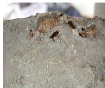
Photos 9 et 10: Fehler im Guss, Blasen und fehlendes Material, Löcher und Krater.
